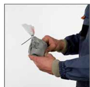
5. Змішати складники, змінюючи торбинку, до отримання однорідної консистенції, після цього залишити на 5 хвилин.
