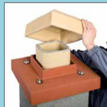
27. Приклеїти керамічне облицювання виходу комину, воно повинно знаходитися на 1 см вище плити.
