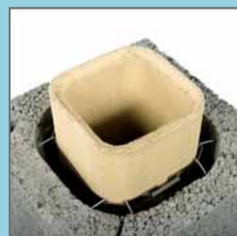
18. Пояски з дистанційними прокладками закладає через кожен 1 п.м. кераміки, на ревізійному отворі і на кожному з'єднанні печі.
